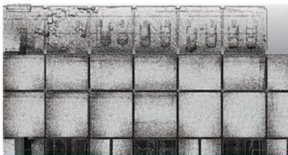
SLAM100旋转式扫描，顶部和底部数据均匀，角落数据完整
